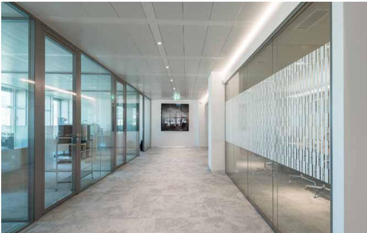
De l'anglais Flush "au même niveau", ce concept indique des portes et cloisons affleurantes, pour un effet visuel sans rupture
