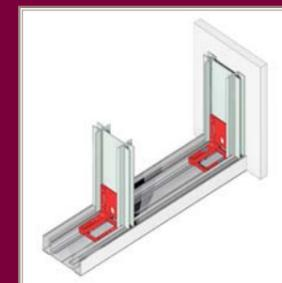
Montage de l'équerre avec un départ mur et un poteau intermédiaire
